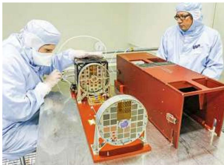
Ausserst sorgfältige Endmontage des Röntgenteleskops im staubfreien Reinraum im Untergeschoss der Fachhochschule Technik in Windisch
