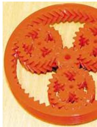
Gedruckt in einem Arbeitsgang, das Modell eines funktionsfähigen Planetengetriebes
